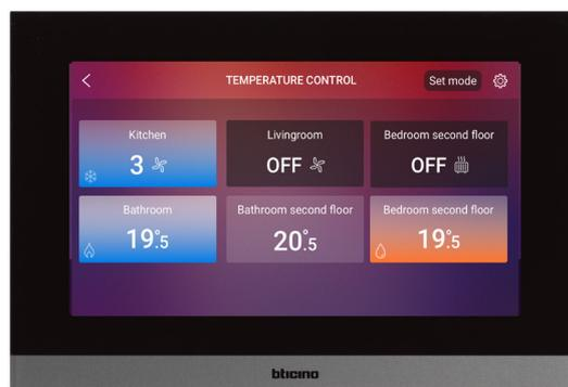
Tela HomeTouch 7”: tela com status das diferentes temperaturas por cômodo e Liga/Desliga do aquecimento. A área em laranja indica que o controle de umidade foi ativado.
